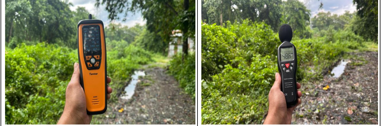
आयोजना क्षेत्र मा वायु (वायु) तथा ध्वनि (दायु) को गुणस्तर मापन गरिदै
